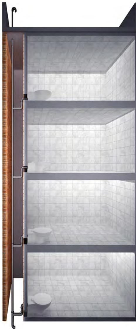
شکل ۷ سیستم فاضلاب با هواکش با قطر کمتر
